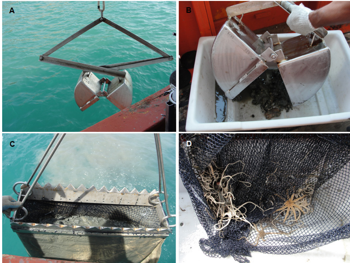
Figura 9.4. (A) Pegador de fundo do tipo van Veen – lance inicial; (B) Pegador de fundo do tipo van Veen – após coleta da amostra, com sedimento; (C) Draga retangular com sedimento. (D) Rede da draga após lavagem. Fotos: Gabriel Monteiro.
