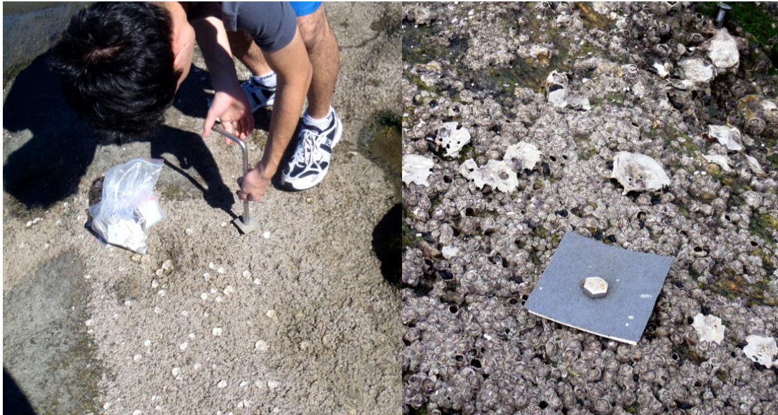
Figura 10.5. Placas de acrílico com fita adesiva antiderrapante utilizadas para quantificação do recrutamento das cracas Chthamalus bisinuatus
