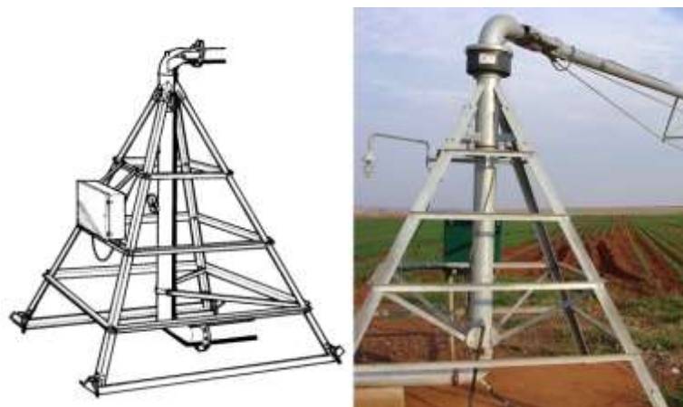
Figura 80: Modelo de torre central de um pivô central (Fonte: Lindsay, 2010).
