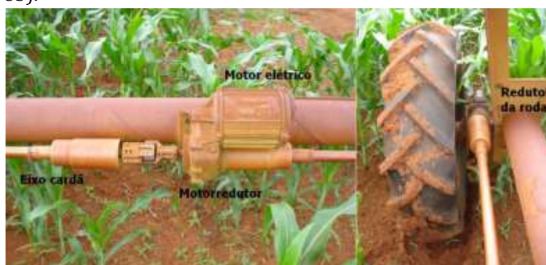
Figura 85: Detalhe do conjunto de motorredução da torre móvel (esquerda) com detalhes da transmissão de movimento por eixo cardã para o redutor de roda (direita).
