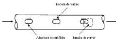
Figura 45: Esquema de um tubo janelado
