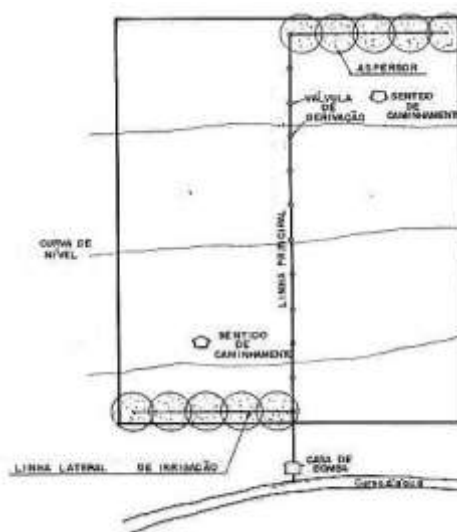
Figura 74: Esquema de movimentação alternada e rotativa em um sistema móvel de aspersão (Fonte: NÚCLEO DE FRUTICULTURA, 2016).
