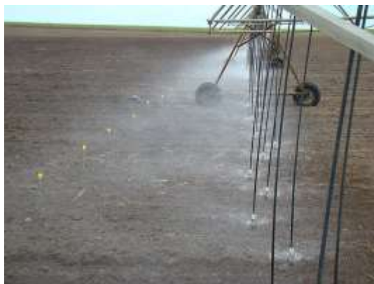
Figura 247: Exemplo de avaliação de campo sendo realizado em um pivô central.
