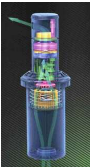
Figura 232: Esquema de um aspersor rotativo de engrenagem utilizado em paisagismo.
