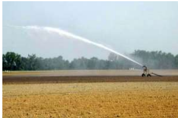
Figura 110: Aspersor canhão instalado em um sistema de carretel enrolador.
