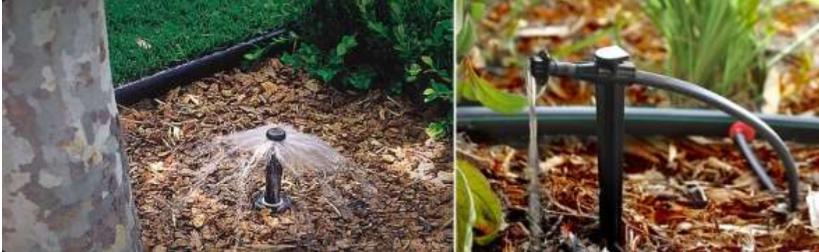
Figura 165: Exemplo da operação de dois tipos de emissores empregados em sistema de borbulhamento (Fonte: HUNTER, 2016 e RAINBIRD, 2016).
