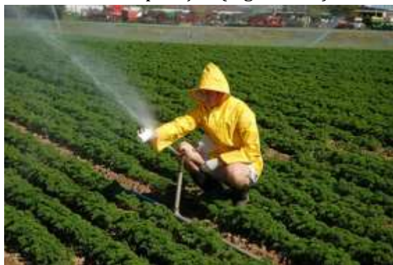
Figura 242: Exemplo de ensaio de campo para estimativa da vazão de um aspersor.
