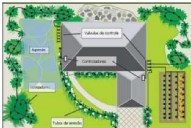
Figura 227: Esquema de um sistema de irrigação para o jardim de uma residência.
