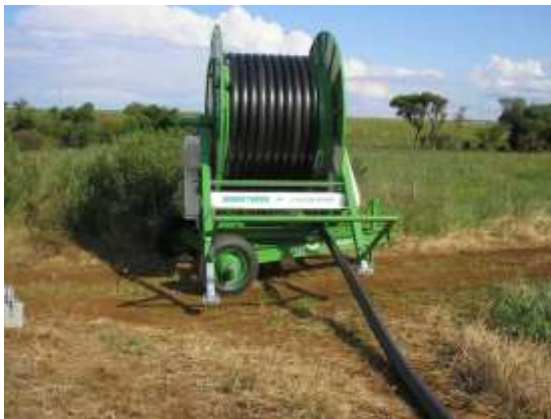
Figura 112: Exemplo de mangueira de polietileno de alta densidade utilizada em autopropelidos.
