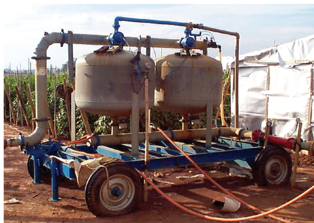
Figura 26. Montagem de um conjunto de filtros de areia sobre carreta móvel.
