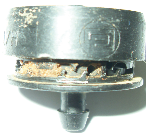
Figura 5. Detalhes de diferentes tipos de gotejadores entupidos por sedimentos presentes na água de irrigação.
