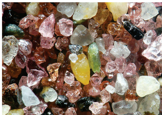
Figura 12. Fotografia microscópica mostrando os diferentes tamanhos de grãos e minerais constituintes da areia de sílica. (Fonte: GREENBERG, 2013)
