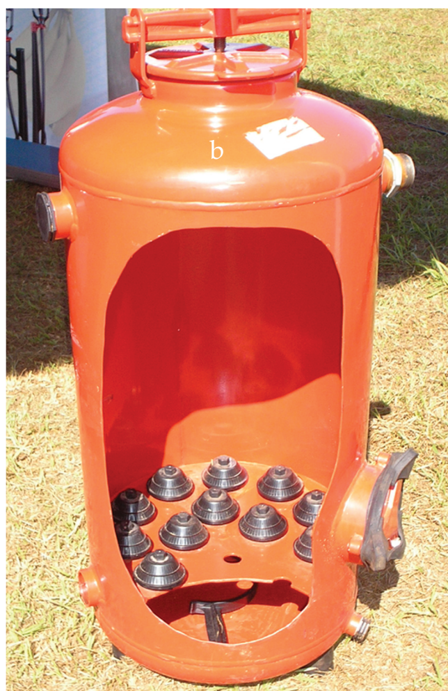
Figura 4. Detalhes da diferença entre um filtro com sistema de drenagem com braços coletores (a) e com crepinas instaladas em fundo falso (b). (Fonte: RAMIREZ, 2011)
