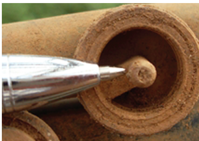
Figura 5. Detalhes de diferentes tipos de gotejadores entupidos por sedimentos presentes na água de irrigação.
