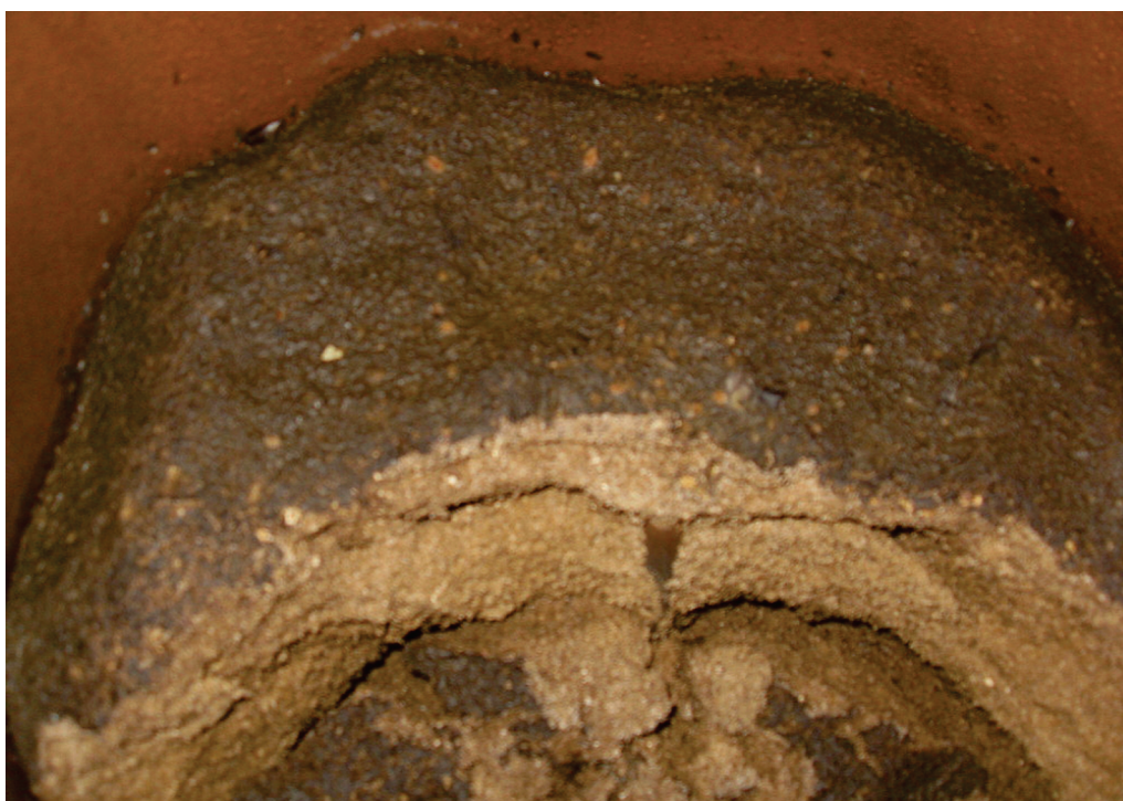
Figura 11. Filtro de areia com formação de camada biológica na superfície do leito filtrante.
