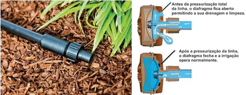
**Figura 100.** Detalhe de uma válvula de drenagem de final de linha com o esquema de operação do diafragma interno. (Fonte: NETAFIM, 2014)
