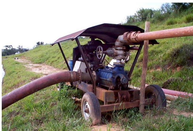
**Figura 121.** Exemplo de sistema motobomba montado sobre carreta com sucção tipo mangote e saída para tubulações metálicas com acoplamentos tipo sela.
