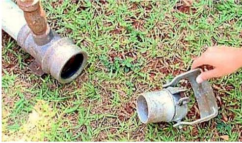
**Figura 48.** Detalhe da colocação de um tampão de fim de linha em aço zincado em uma linha lateral de aspersão.
