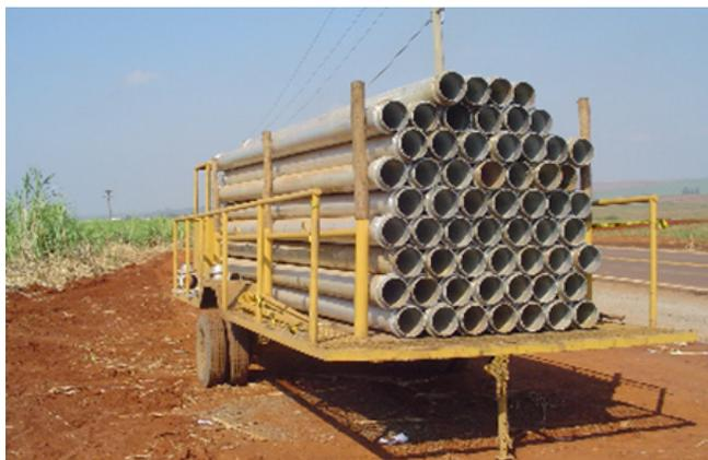
**Figura 29.** Detalhe de carreta com tubos de alumínio para movimentação na área irrigada.
