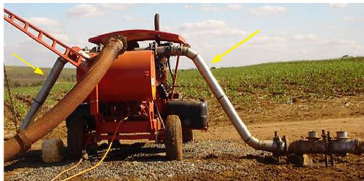
**Figura 36.** Detalhe da aplicação de tubos de aço inoxidável na sucção e adução (setas) de um equipamento de montagem direta para aplicação de vinhaça. (Fonte: RAESA, 2014)
