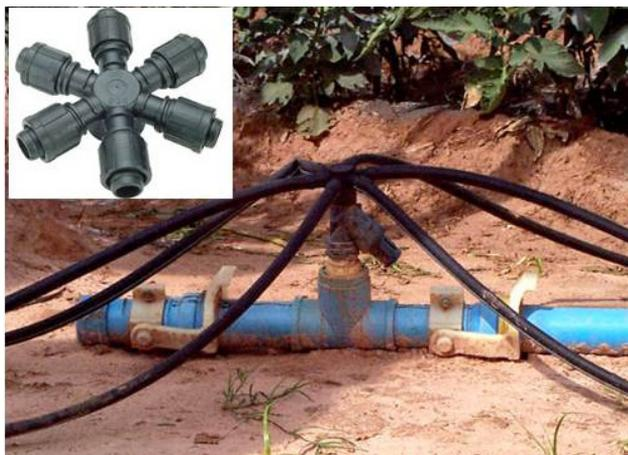
**Figura 56.** Detalhe de uma conexão de derivação para seis saídas de linhas de gotejamento.
