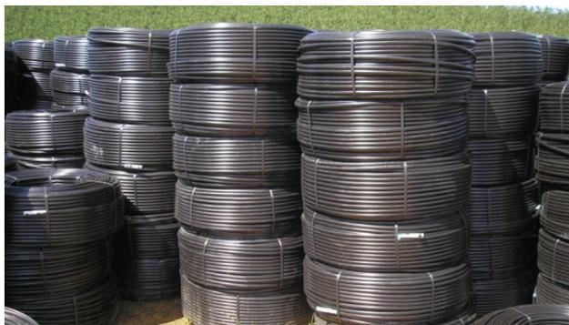
**Figura 14.** Exemplo de diversos rolos de tubos de PE disposto no campo. (Fonte: ANTUNES, 2006)
