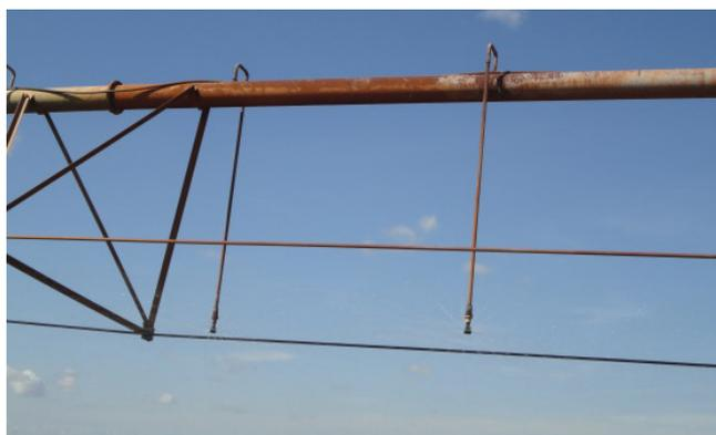
**Figura 23.** Exemplo de oxidação externa de um tubo de aço zincado em um pivô central.
