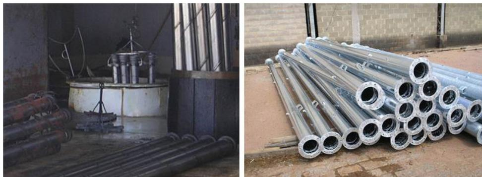
**Figura 26.** Detalhe do processo de galvanização a quente com tubos colocados na posição vertical no banho de zinco e tubos após a galvanização.
