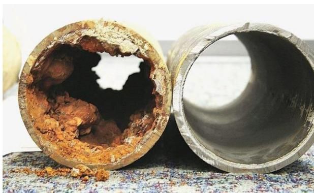
**Figura 33.** Exemplo de tubo de ferro fundido com corrosão interna. (Fonte: GAZETTE.NET, 2014)
