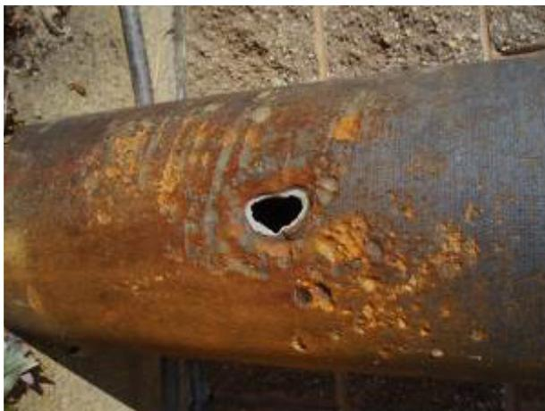
**Figura 24.** Exemplo de corrosão alveolar em tubos de aço. (Fonte: FIBERNEERINGS, 2015)
