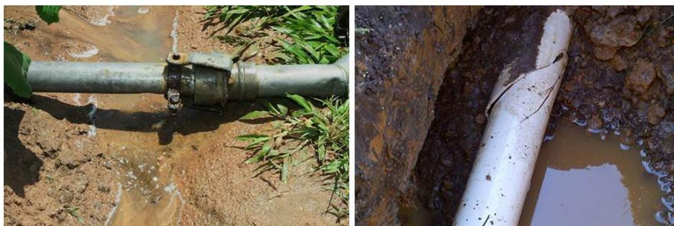
**Figura 133.** Exemplo de vazamentos em tubulações de irrigação.
