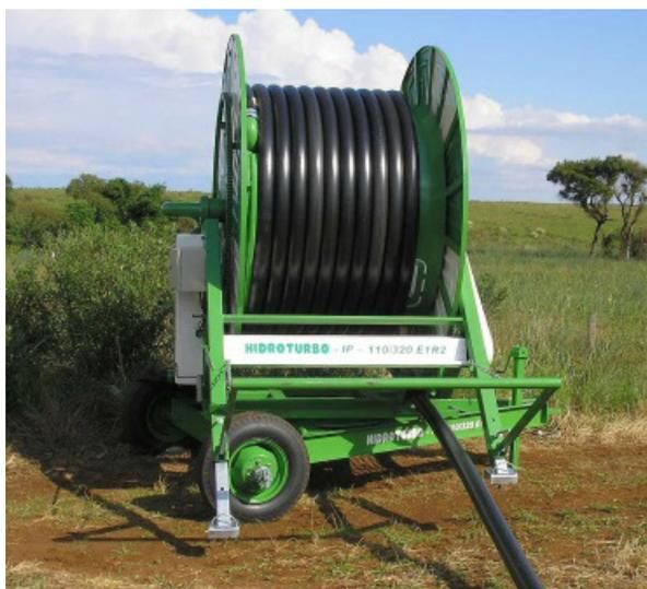
**Figura 17.** Detalhe de um carretel enrolador com mangueiras de PE de média densidade.
