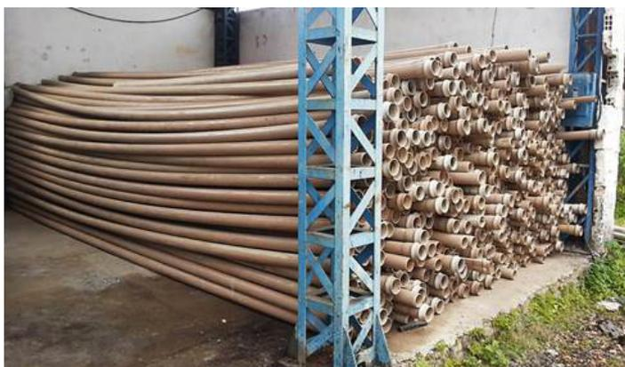
**Figura 113.** Exemplo de armazenamento de tubos de PVC. (Fonte: ONCMETAIS, 2014)
