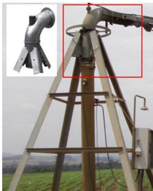
**Figura 49.** Detalhe da curva de conexão giratória de um pivô central com destaque para a peça isolada antes da montagem.
