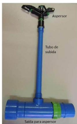
**Figura 54.** Detalhe da montagem da estrutura de fixação do aspersor. (Fonte: MFRURAL, 2014)
