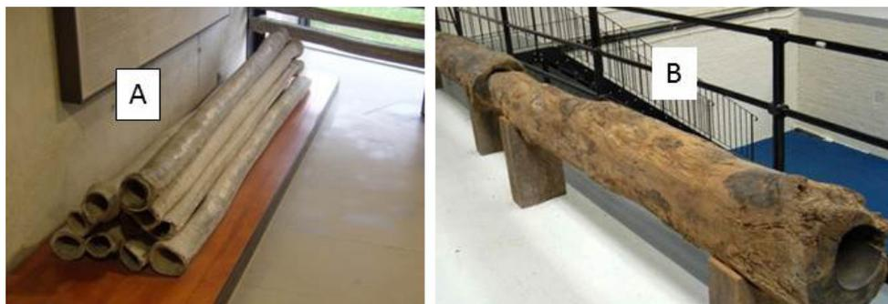
**Figura 6.** Dois tipos de tubos fabricados na antiguidade: (A) tubo de chumbo na Roma antiga e (B) tubo de madeira utilizado em Londres entre os séculos XVI e XVIII. (Fonte: SCHRAM et al., 2014 e SCHLADWEILER, 2014, respectivamente)
