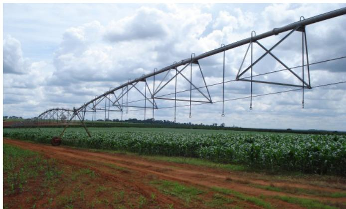
**Figura 20.** Detalhe de um lance de pivô central montado a partir de tubos de aço zincado.
