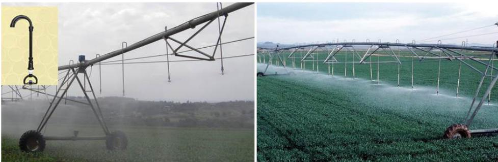
**Figura 51.** Exemplos da utilização da conexão por pendural em pivô central, com destaque para a peça isolada. (Fonte: PLASNOVA, 2014)
