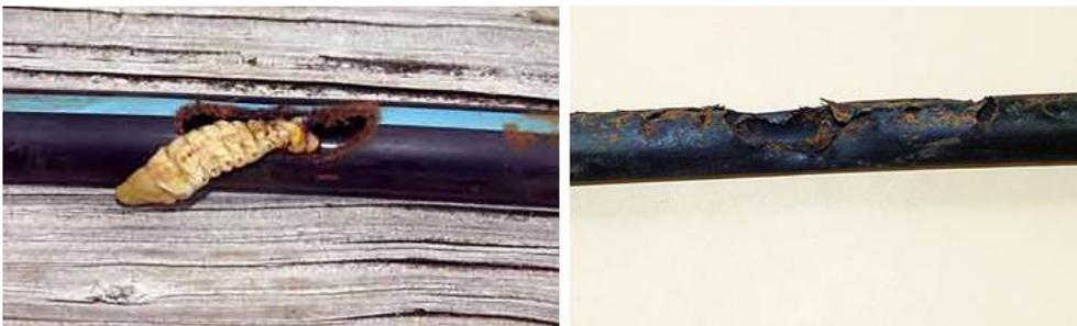
**Figura 16.** Exemplo de tubulação de polietileno atacada por larva e por roedores. (Fonte: THOMPSON, 2014)
