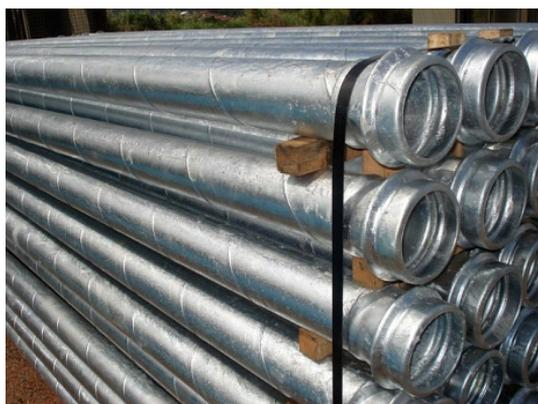
**Figura 21.** Tubulações de aço zincado. (Fonte: JIMENEZ, 2014)
