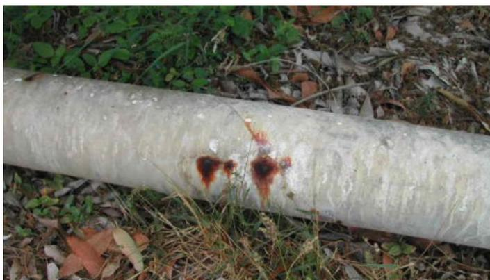
**Figura 22.** Exemplo de corrosão interna em tubo de aço zincado.
