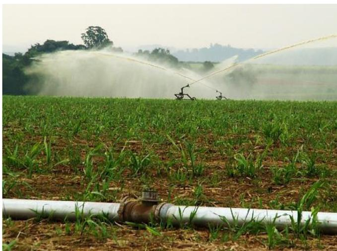
**Figura 28.** Exemplo de aplicação de tubos de alumínio na aplicação de vinhaça. (Fonte: RAESA,2014)
