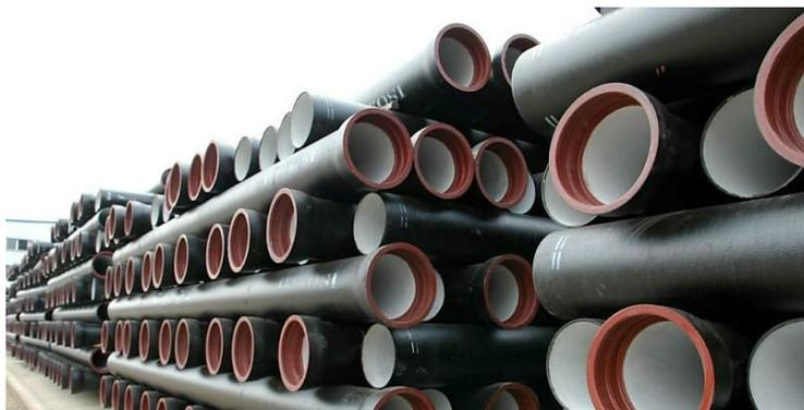
**Figura 32.** Tubos de ferro fundido armazenados. (Fonte: RFCOMERCIAL, 2014)
