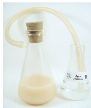
Figura 16.1.7: montagem do Kitasato com a mangueira.
