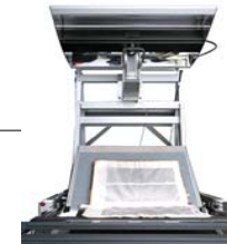
2 „Grazer Kameratische“ mit Scan- kopf für Handschriften und Alte Drucke (A3, bis 600ppi, Farbe)
