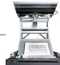
2 „Grazer Kameratische“ mit Scan- kopf für Handschriften und Alte Drucke (A3, bis 600ppi, Farbe)
