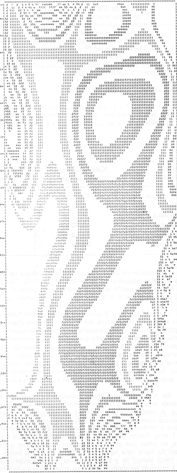
Figura 2 — Mapa de superfície de tendência para os dados batimétricos, como definida pelo polinômio de 8º grau. A equidistância das curvas é de 1 m, a partir do símbolo 0.
