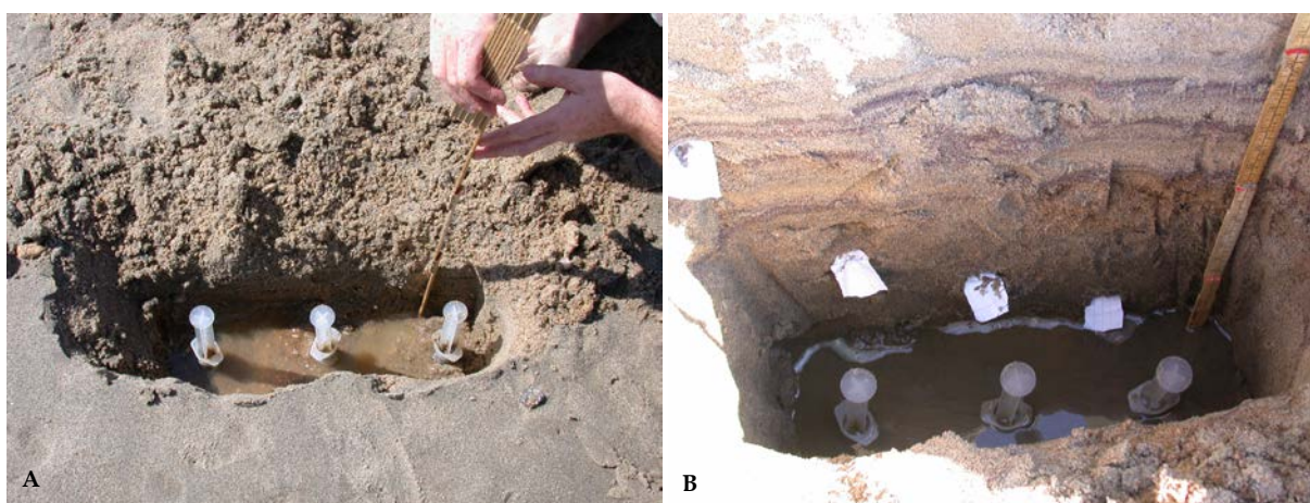
Figura 2.6 Procedimentos para coleta de amostras quantitativas em diferentes extratos da praia de São Francisco: (A) no nível inferior, coleta de três amostras no extrato 10-20 cm de profundidade; (B) no nível intermediário, no extrato 40-50 cm de profundidade (as marcas brancas na parede do buraco indicam os limites inferiores dos extratos já amostrados).
