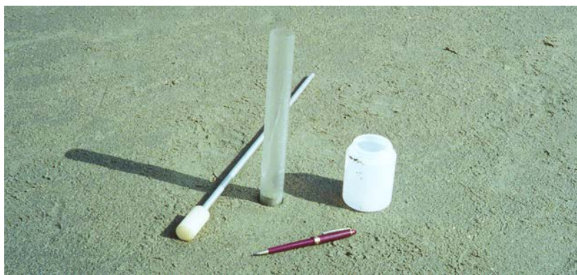
Figura 2.5 Amostrador cilíndrico (0,007 m 2 ) para coleta da meiofauna em praias arenosas.
