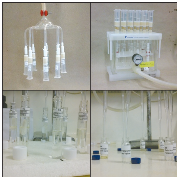
Figura 4: Etapas de preparo de amostra após recebimento dos cartuchos na Unicamp. Da esquerda para a direita: secagem do cartucho, eluição, secagem do eluato com N_2 e etapa final no frasco coletor antes da análise instrumental
